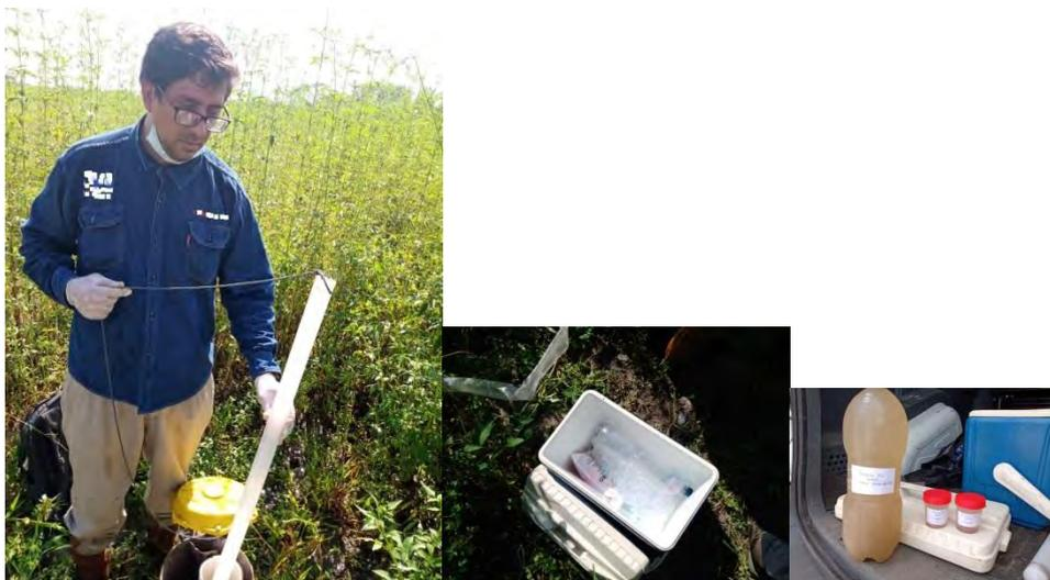
Figura N° 5.2 Toma de muestra con dispositivo bailer, etiquetado y refrigerado para su traslado
