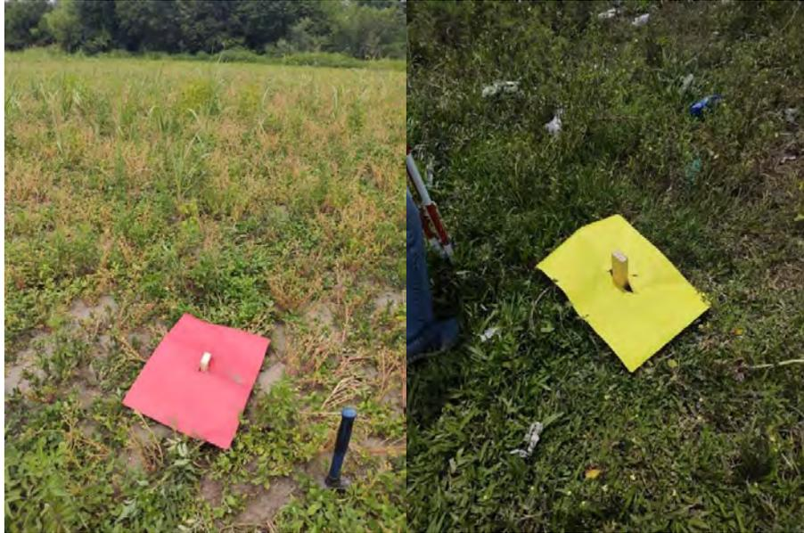
Imagen 2.2: Señalización de los Puntos de apoyo fotogramétrico.
