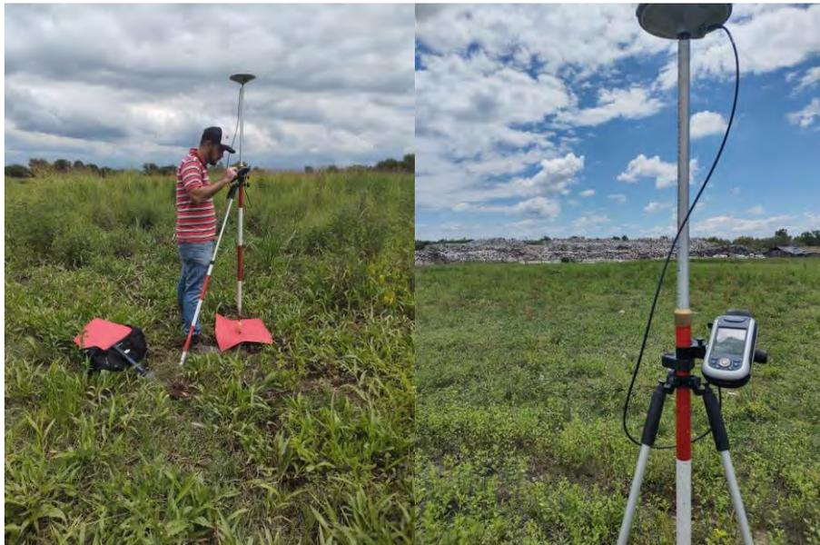
Imagen 2.3: Medición de los puntos de Apoyo fotogramétrico.
